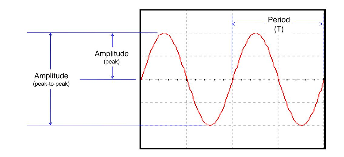
Parts of an analog signal: amplitude, period, Phase & frequency. Analog sinyal cok sayıda farklı frekansları, fazları ve genlikleri olan sinüsoidal sinyalerin bileşmesinden oluşur.
